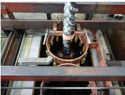
*Le fotografie mostrano vasche verticali utilizzate per pezzi di grandi dimensioni per vari mercati (ingegneria, automotive, aerospaziale, petrolio e gas, industria mineraria, idraulica, ecc.).*
