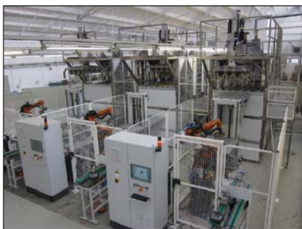
Le fotografie mostrano reattori a celle chiuse utilizzati nella cromatura di aste di pistone e valvole del motore.
