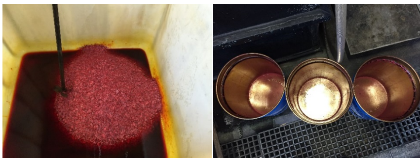
Queste foto mostrano a sinistra il triossido di cromo addizionato con acqua per ridurre la polvere durante la miscelazione, a destra, fusti vuoti.
