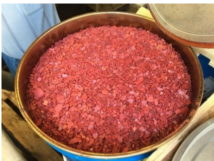
La foto mostra un fusto aperto contenente scaglie di triossido di cromo
