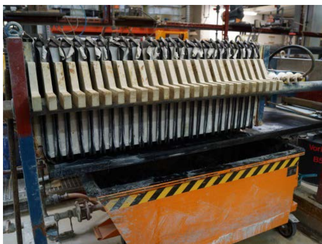
La photo montre un filtre-press pour la déshydratation des solides dans une station de traitement des eaux usées.
