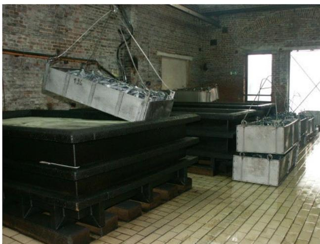
Les photos montrent (à gauche) des racks de pièces immergés dans un bain de traitement de surface, (à droite) un panier de pièces sortant d'un bain de traitement de surface. Le panier est incliné pour permettre une meilleure vidange et réduire l'entraînement de la solution de traitement vers la cuve de rinçage.
