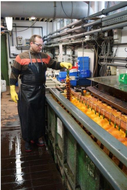
! La photo montre le placage dans des cuves ouvertes avec un chargement manuel non conforme à cette fiche car le filtre P3 est absent.
