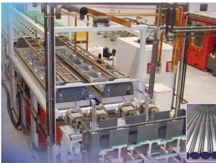
Les photographies montrent des cuves couvertes utilisées pour le placage en héliogravure et le placage en continu de barres hydrauliques.
