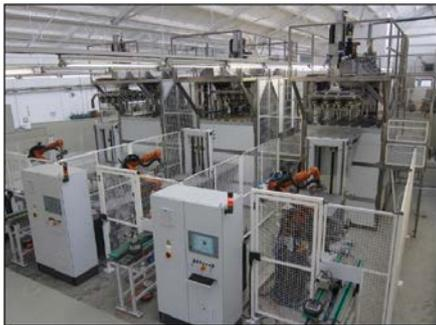
Les photographies montrent des cellules de réacteur fermées utilisées pour le placage de tiges de piston et de soupapes de moteur.
