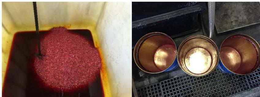
Les photos montrent (à gauche) des flocons de trioxyde de chrome avec ajout d'eau pour réduire la poussière pendant le mélange et (à droite) des fûts vides.
