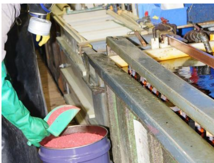
Die Abbildung zeigt die Badeinstellung mittels Chromtrioxid-Zugabe.
