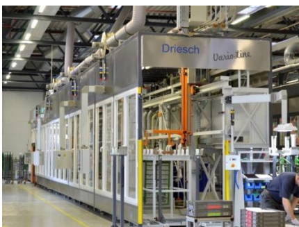
Die Abbildungen zeigen Galvanisierkammern mit räumlich getrenntem Galvanisierungsprozess und Transporteinrichtungen.
