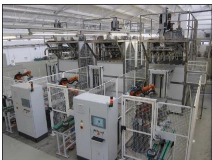
Abbildungen: Ansicht einer geschlossenen Reaktorzelle zum Beschichten von Kolbenstangen und Motorventilen
