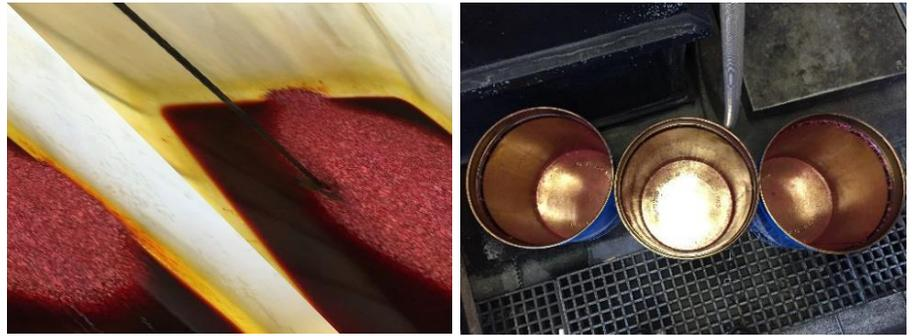
Die linke Abbildung zeigt Chromtrioxid-Flakes, die zur Reduzierung der Staubentwicklung beim Mischvorgang mit Wasser versetzt werden und (rechts) leere Fässer.
