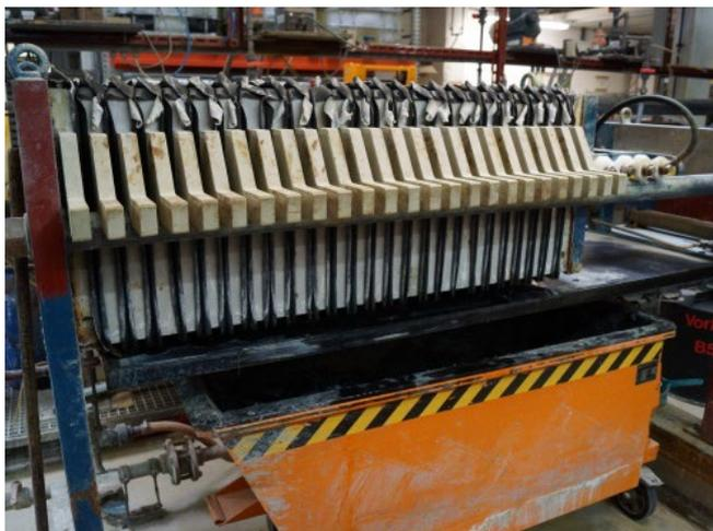
La fotografía muestra el filtro prensa para la deshidratación de sólidos en la planta de tratamiento de aguas residuales.
