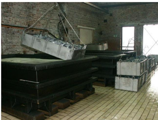
Las fotografías (izquierda) muestran bastidores de piezas inmersas en un baño de tratamiento de superficies, y una cesta de piezas (derecha) que se extrae de un baño de tratamiento. La cesta se encuentra inclinada para permitir un mejor drenaje y reducir el paso de la solución del proceso al tanque de enjuague.
