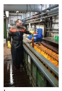
La fotografía muestra un revestimiento en tanques abiertos con carga manual que no cumple con esta GBP al no contar con el filtro P3.
