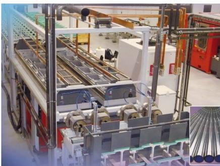
Las fotografías muestran los tanques cubiertos utilizados en el rotograbado y el revestimiento continuo de barras hidráulicas.
