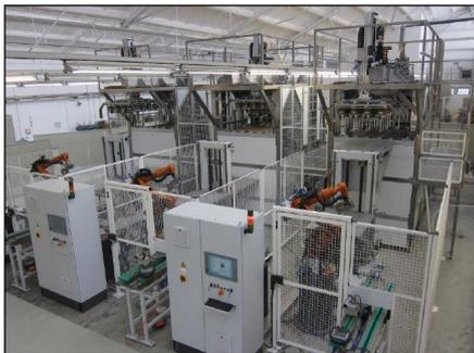
Las fotografías muestran celdas de reactor cerradas utilizadas en el revestimiento de vástagos de pistón y válvulas de motor.
