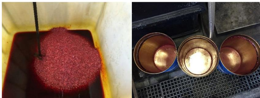
Las fotografías muestran escamas de trióxido (izquierda) con agua añadida para reducir el polvo durante la mezcla y (derecha) bidones vacíos
